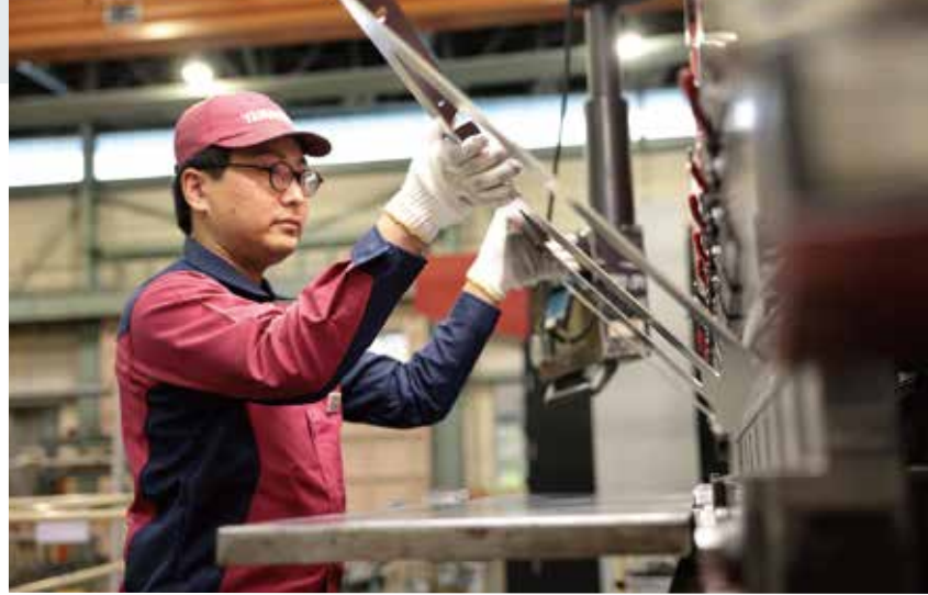
プレスブレーキで板金加工する庄司和洋さん。大きな鉄板の形状が一瞬で変わる。作業効率を考えながら段取りを組んでいく
