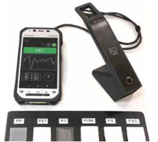
庄司さんが開発に携わった「ぶらしる」。プラスチック製品でも材料は微妙に異なっており、センサーで材質を判別できる。モノの大きさや形状に対応して、持ち方を変えられるのが特長
