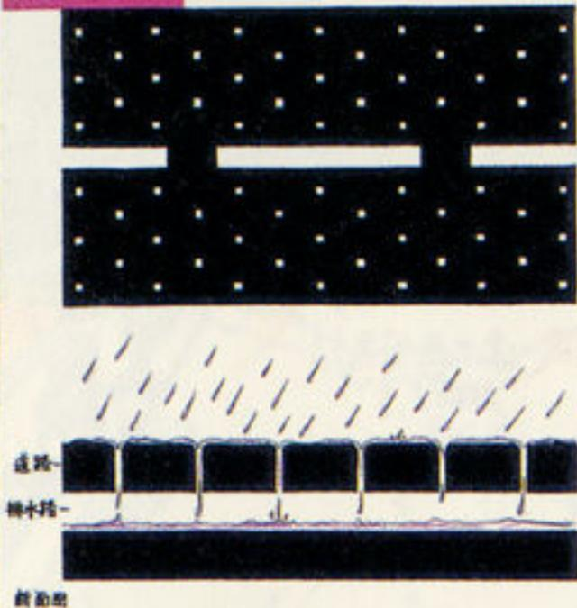
道路に小さな無数の穴を開け、雨天の場合は、穴を通過した水が排水路を過って流れ出す。これにより、道路表面は常にドライでスリップ事故を防ぐ。また、雪、凍結などの場合は排水路に溜水を流すことにより、穴から伝わる熱で雪や氷を解かすことが出来る。
