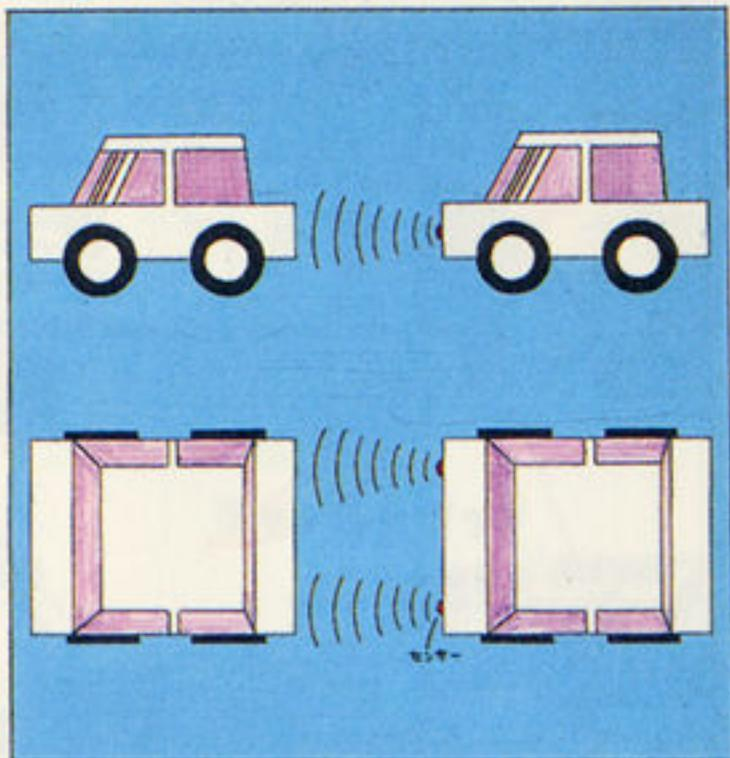
車の前後に追突防止センサーを取り付け車間距離がスピードと比例して設定される。センサー前後の車をキャッチした場合は、運転者に警報ベルで知らせると同時に、速度も自動で減速される。
